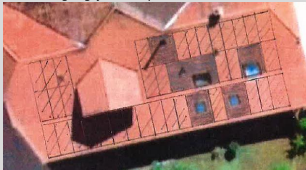
Bild: Nach Korrektur genügend angepasste Anlage -> baubewilligungsfrei
