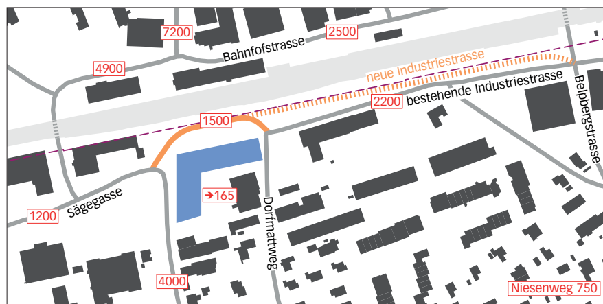
Abb. 9 Geschätzte Verkehrsmengen DTV nach der Realisierung der UeO q «Senevita» (ca. 2019)
