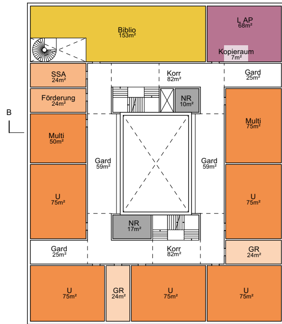
1. Obergeschoss GF 1'356 m 2 / 823 m 2 HNF
