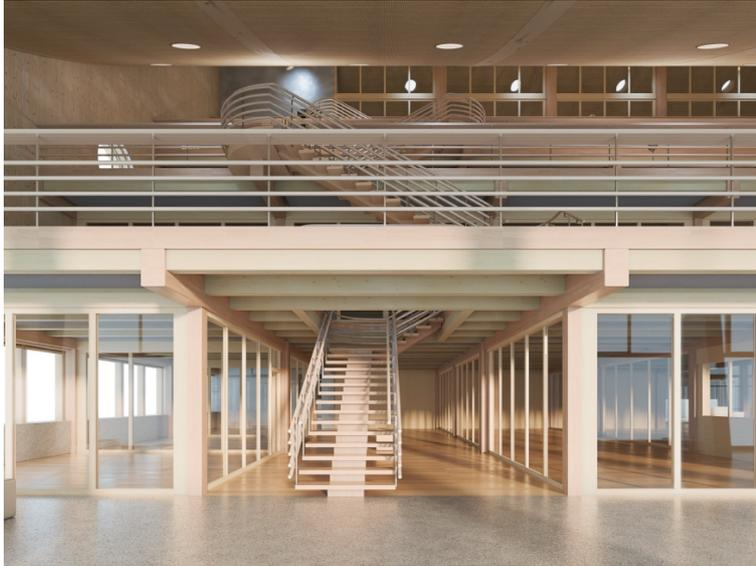
Treppenaufgang unter Holzbetonverbunddecken und Hängetragwerk
