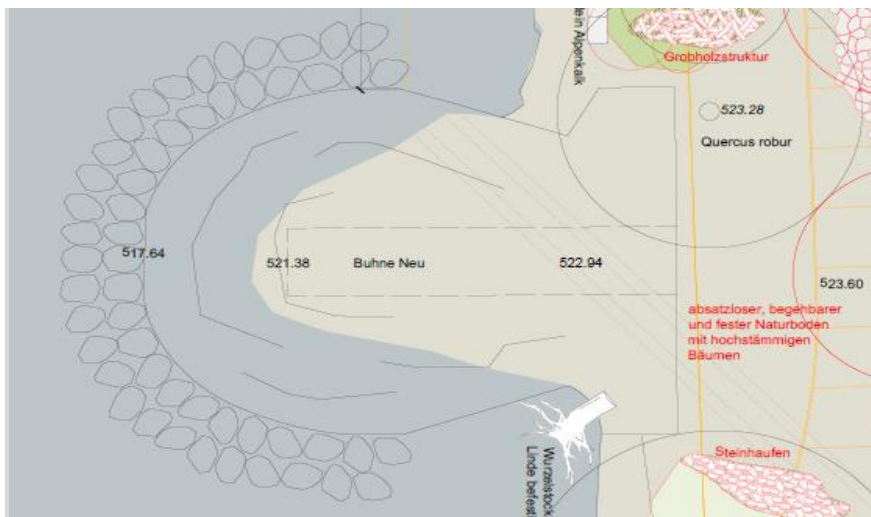
Abbildung: Neue Bühne in der Aare zum Uferschutz
