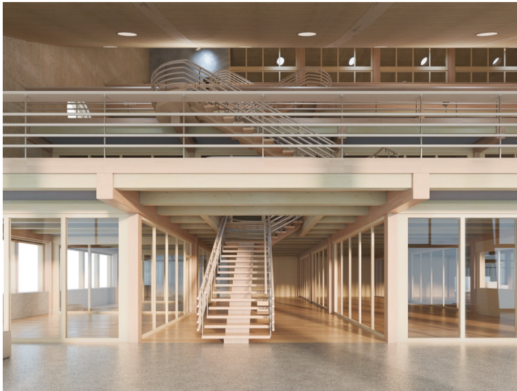
Treppenaufgang unter Hozbetonverbunddecken und Hängetragwerk
