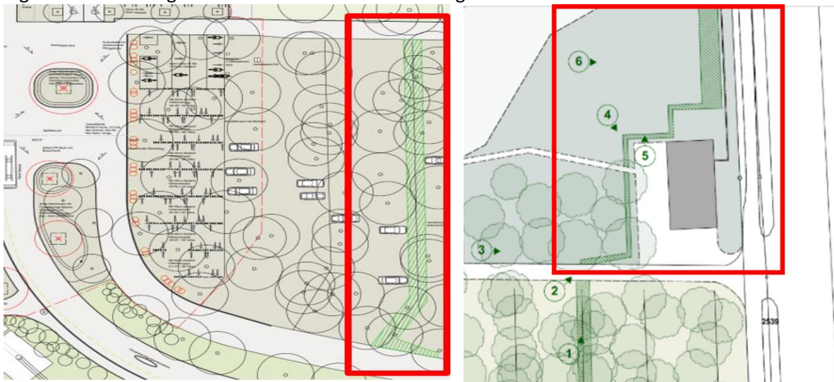
Abbildung: Kleintierkorridor zur Längsvernetzung, links Badi Vorplatz, rechts geplante Fortsetzung im Parkbad
