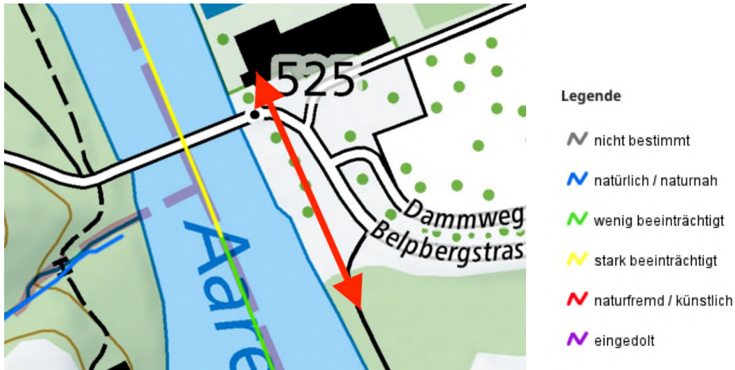
Abbildung 11: Ökomorphologie Stufe F - Abschnitte auf dem Projektperimeter (mit einem roten Pfeil verdeutlicht), Quelle: Swisstopo.
